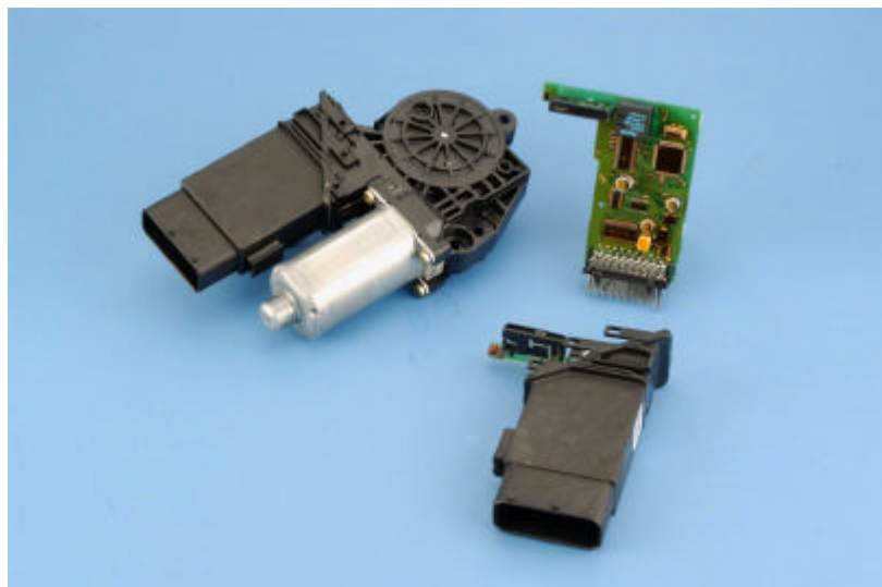
Abb. 6: Türsteuergeräte adaptiert am FH-Motor, seit 1996
