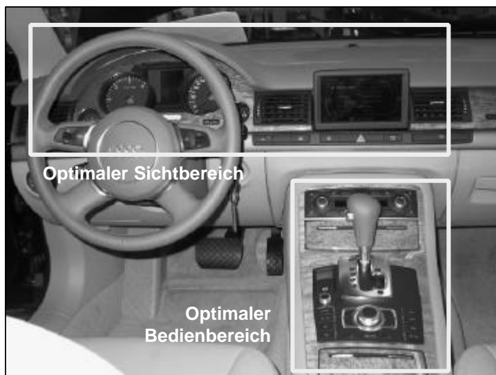
Bild 3: Trennung von Anzeige und Bedienung beim MMI
