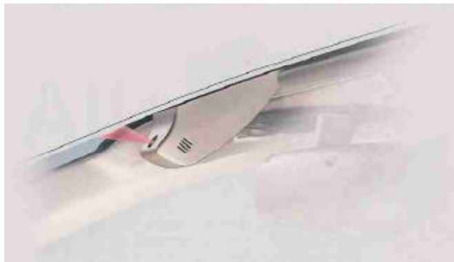
Bild 10: Sensorpaket für Feuchte, Temperatur und Infrarotstrahlung
