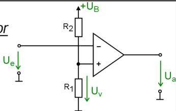
Für  $U_e > U_v$  gilt  $U_a \rightarrow -\infty$  bzw. durch die Begrenzung der Ausgangsspannung auf die Betriebsspannung:  $U_a \rightarrow -U_B$
