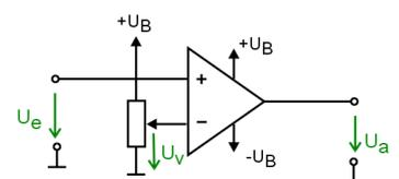
Für  $U_e > U_v$  gilt  $U_a \rightarrow \infty$  bzw. durch die Begrenzung der Ausgangsspannung auf die Betriebsspannung:  $U_a \rightarrow +U_B$
