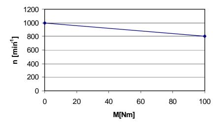
Werte:  $n_N = 800 \text{ min}^{-1}$ ,  $U_N = 400 \text{ V}$
