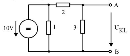
a) Berechnen Sie die sich ergebende Quellenspannung  $U_{KL}!$
