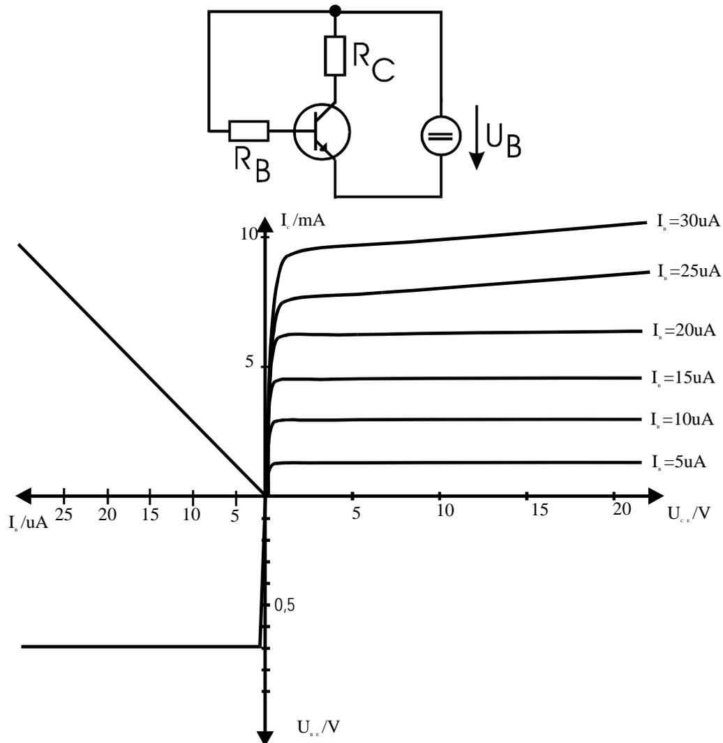
Werte:  $U_B = 15\text{V}$ ,  $R_C = 1,5\text{k}\Omega$ ,  $R_B = 1,43\text{M}\Omega$
